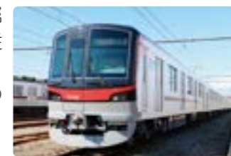
アルミ合金製の軽量車体
